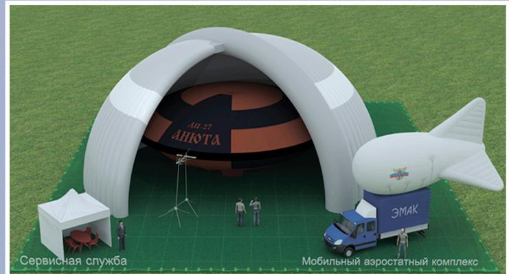
Главной отличительной особенностью дирижабля линзообразной формы серии ДП-27 является осевая симметрия его оболочки, что дает возможность аппарату более результативно сохранять свое положение в заданной точке зависания во время выполнения полётов при набегающем потоке и разноосных порывах ветра. Линзообразная форма оболочки дирижабля дает также возможность обеспечить стоянку аппарата на земле на открытом пространстве (без флюгирования) с помощью только растяжек и якорей.
